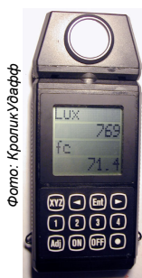
Люксметр для измерения освещенности
